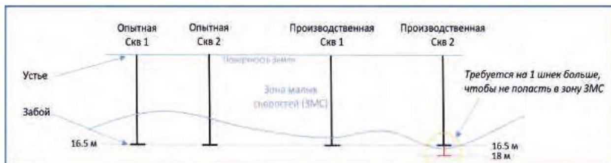
▼ Рис. 3. Возможная ошибка при выборе глубины заложения заряда в скважину.
