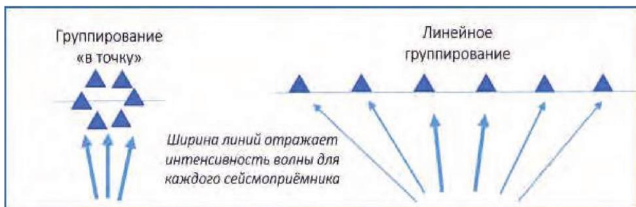
▲ Рис. 1. Схема регистрации вертикально приходящей волны при разных типах группирования сейсмоприёмников.
