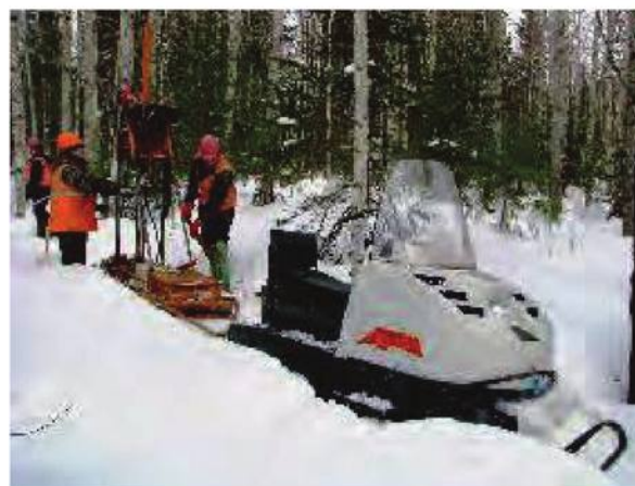
▲ Рис. 2. Компонировка самоходной буровой установки УБШМ-1-13 для зимних работ. Буксировка осуществляется снегоходами «Буран».
