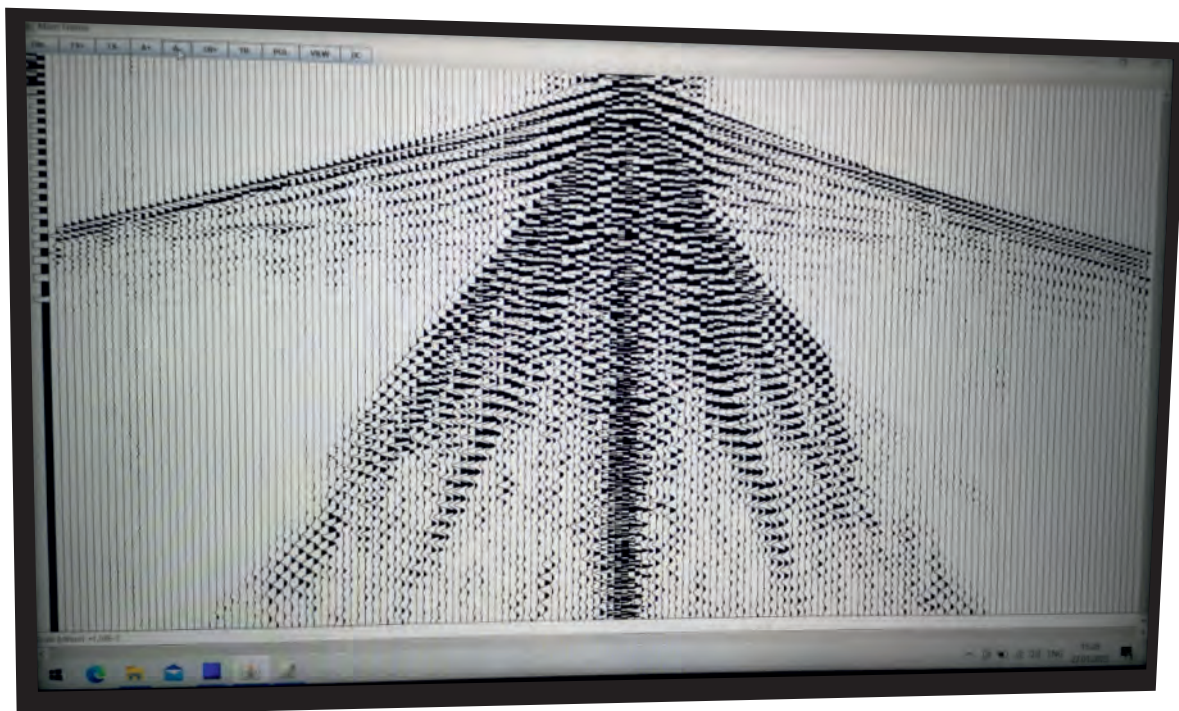
▲ Рис. 6. Сейсмограмма, полученная в ходе опытно-промышленного тестирования Геотом.
