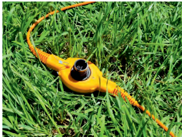
▲ Рис. 3. Кабельный элемент «Сейсмосистемы» (модуль телеметрический МТ-1).
