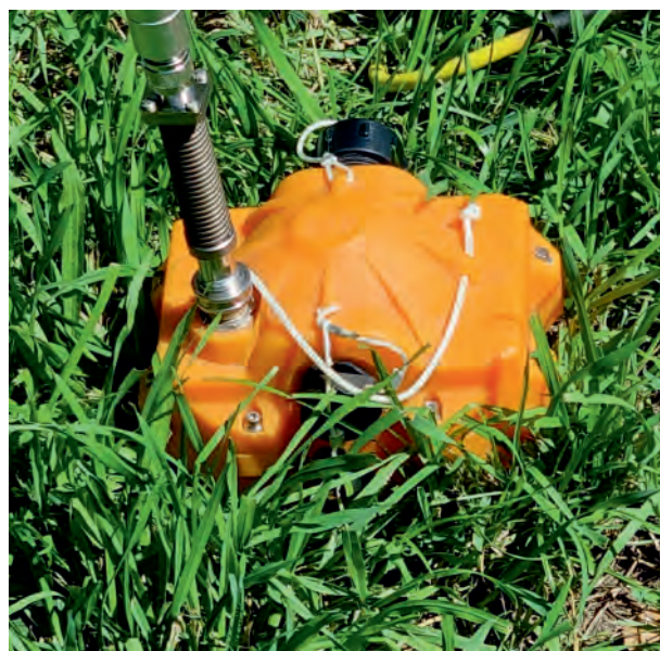
▲ Рис. 4. Бескабельный автономный регистратор «Сейсмосистемы» (блок БАР) для организации обходов препятствий на линии профиля.
