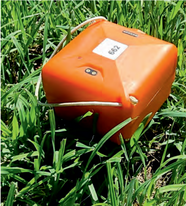
▲ Рис. 6. Бескабельный автономный регистратор «Сейсмосистемы» (блок БАРС) со встроенным геофоном.
