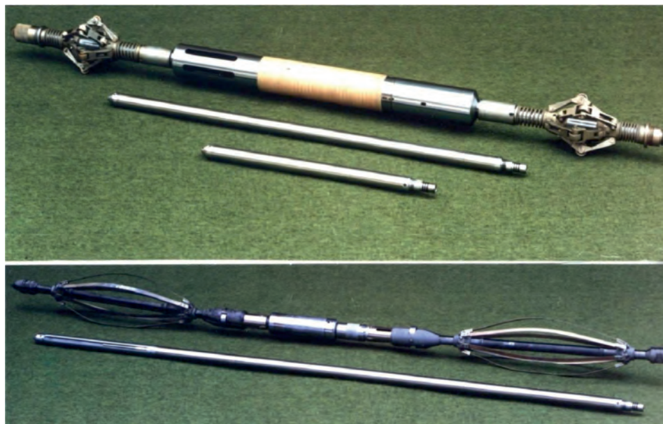
◀ Рис. 3. Комплекс геофизических приборов для контроля технического состояния крепи скважин.
