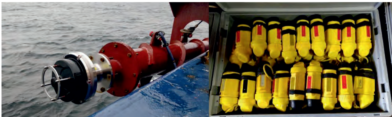
▲ Рис. 2. Система гидроакустического позиционирования «Пикет». Антенна (слева) и набор маяков-ответчиков (справа).
