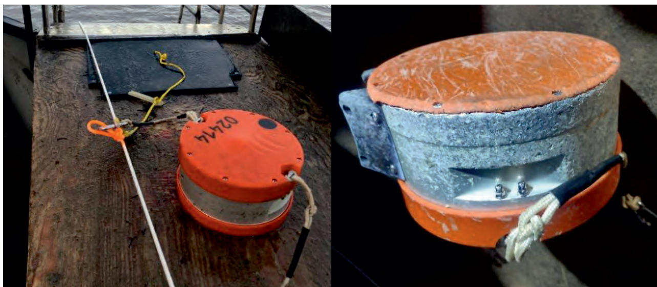
▼ Рис. 1. Донная станция «Краб» перед спуском в воду (слева) и поднятая из воды после волочения несколько километров по дну (справа).
