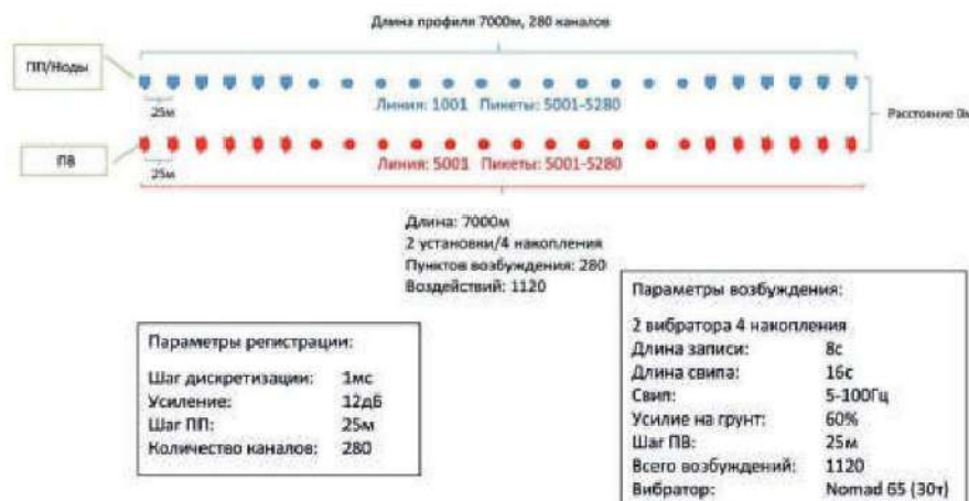
Рис. 5. Развертывание оборудования ALLSEIS-1C для опытных работ.
