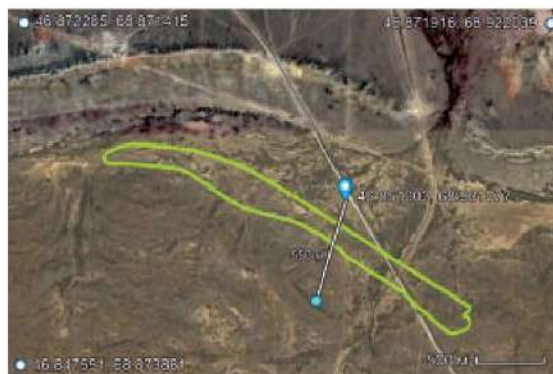
▲ Рис. 2. Карта проведения полевых работ с нанесенным профилем наблюдений и контуром рудного тела на руднике Жаман-Айбат.
