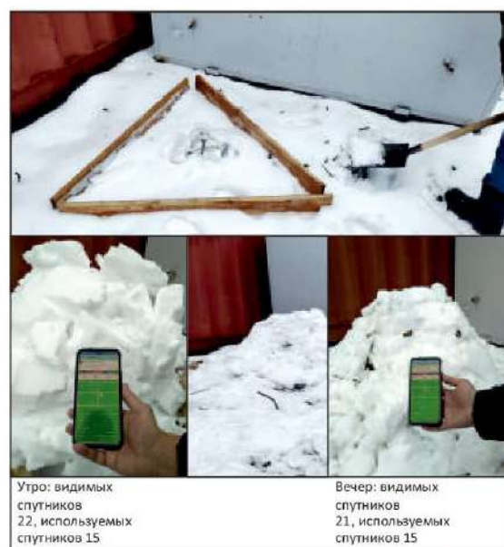
▼ Рис. 8. Оценка работоспособности ALLSEIS 1C в условиях снежного покрова.
