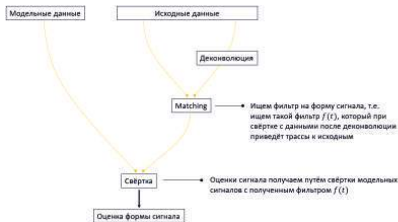
◀ Рис. 5. Схема получения оценки формы сигнала
