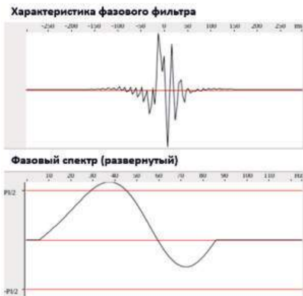
▲ Рис. 15. Характеристика фазового фильтра.
