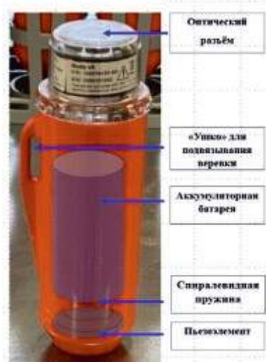
▼ Рис. 1. Вид и комплектность нодального приёмника Stryde.
