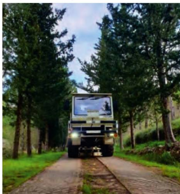
▼ Рис. 4. Виброисточник INOVA UniVib2 или UV2 на проекте в Сицилии.
