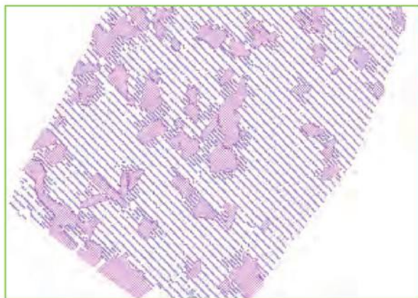
▲ Рис. 1. Схема расстановки приемников на месторождении Марцеллус (США). *Розовый цвет – невозможные для размещения оборудования участки.
