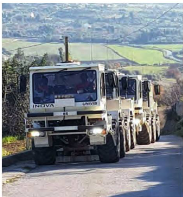
▼ Рис. 4. Виброисточник INOVA UniVib2 или UV2 на проекте в Сицилии.
