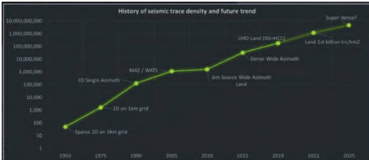
▲ Рис. 3. Увеличение количества трасс на 1 кв.км с начала сейсморазведки.
