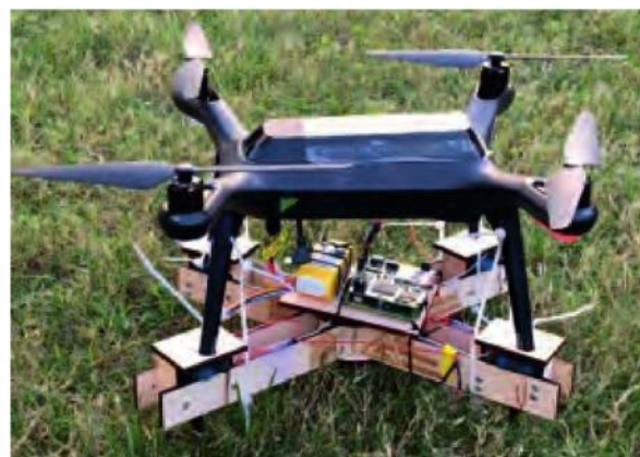
▲ Рис. 1. Сейсмический квадрокоптер с прикрепленной к нему четвероногой записывающей платформой с сейсмоприемниками в каждой из ног. Модифицированный рисунок из [Stewart et al., 2016].
