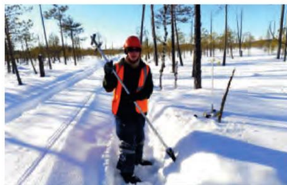
▼ Рис. 3. Работа с погрузателем сейсμοприемников.
