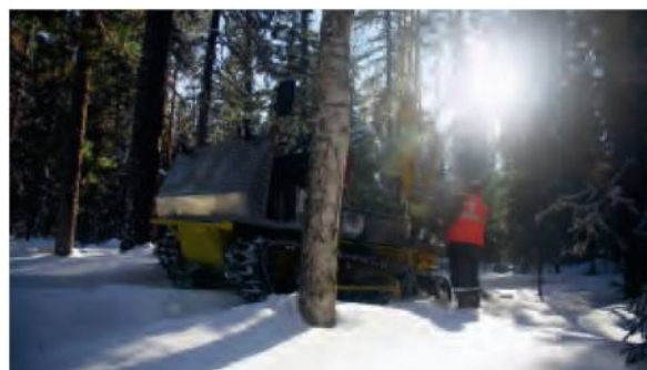
▲ Рис. 2. Малогабаритная буровая установка УБГМ-1М на базе ШС 0.6.
