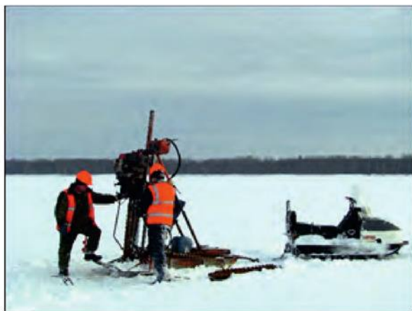
▲ Рис. 4. Варианты исполнения облегченной буровой установки УБШМ-1-13.
