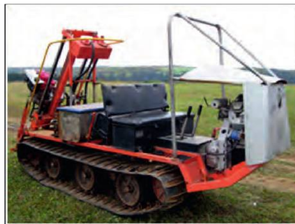
▲ Рис. 4. Варианты исполнения облегченной буровой установки УБШМ-1-13.
