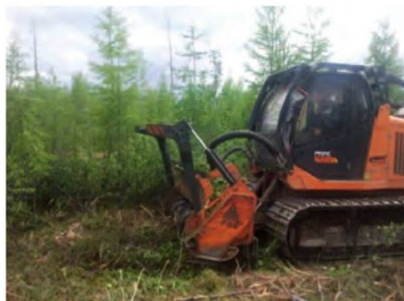
▼ Рис. 2. Мульчер для расчистки криволинейных просек в обход крупных деревьев.
