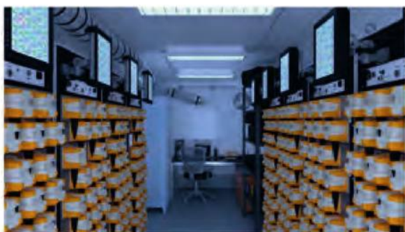
▲ Рис. 8. Контейнер со стеллажами для узлов бескабельной регистрирующей системы. Обычно считывание сейсмических данных и зарядка встроенных аккумуляторов происходит одновременно.
