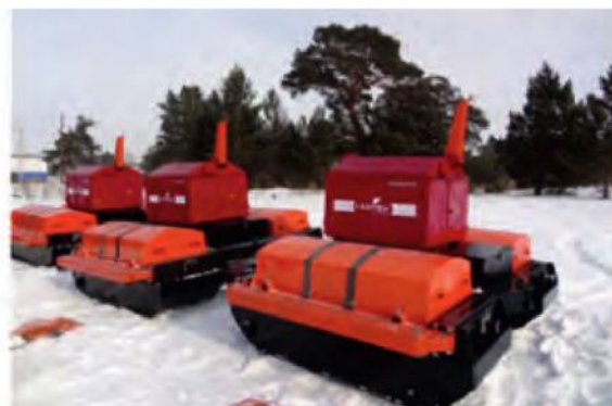
▲ Рис. 6. Сцепка буксируемых электромагнитных импульсных источников «Енисей СЭМ-100».
