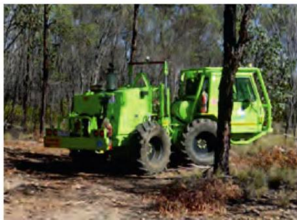
▼ Рис. 3. Легкий виброисточник для передвижения по узким криволинейным профилям.
