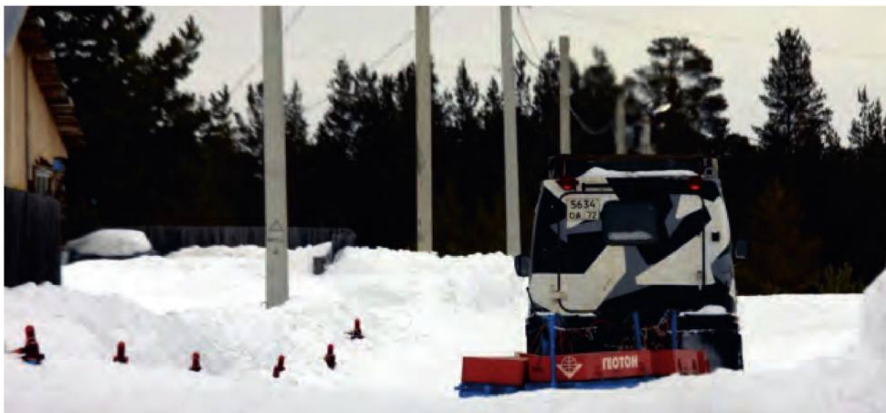
▲ Рис. 3. GEOTOM – работа в условиях населенного пункта по высокоплотным методикам.
