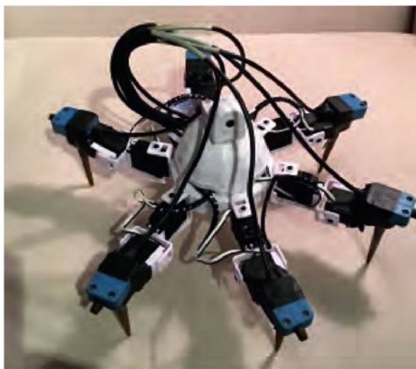
▲ Рис. 3. Самоходный шестирычажный робот, транспортируемый дроном. К каждому рычагу прикреплен сейсмоприемник. Модифицированный рисунок из [Stewart et al., 2016].
