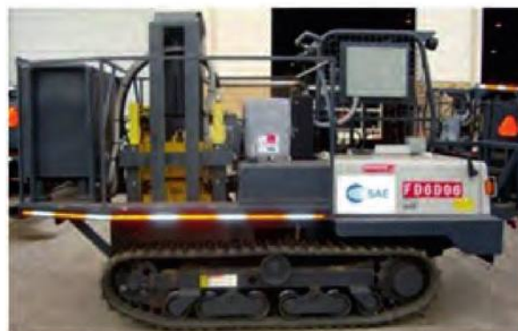
▼ Рис. 7. Портативный импульсный источник onSEIS на гусеничном шасси.
