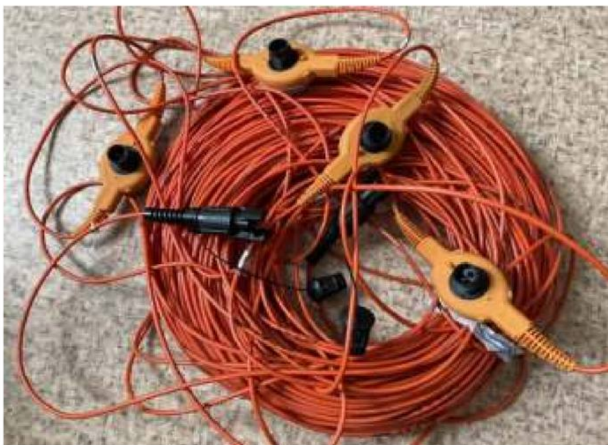
◀ Рис. 5. Кабельный телеметрический модуль.
