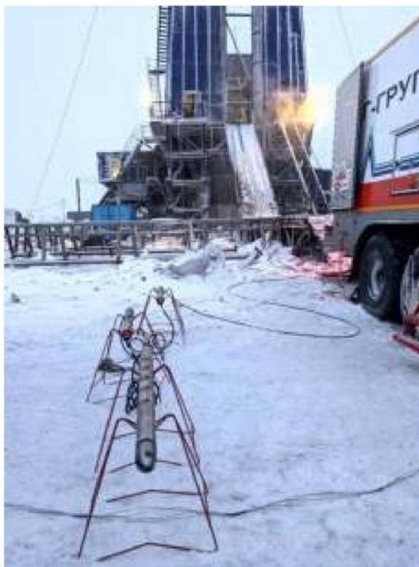
▲ Рис. 4. Зонд Geochain X HP готов к работ на скважине.
