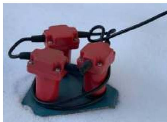
▲ Рис. 2. Точечная 3-приборная группа геофонов на металлической подставке.
