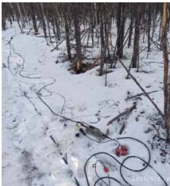
▲ Рис. 3. Параллельно разложенные две линии приёма со стандартными 25-метровыми линейными группами геофонов и 3-приборными группами «в точке».
