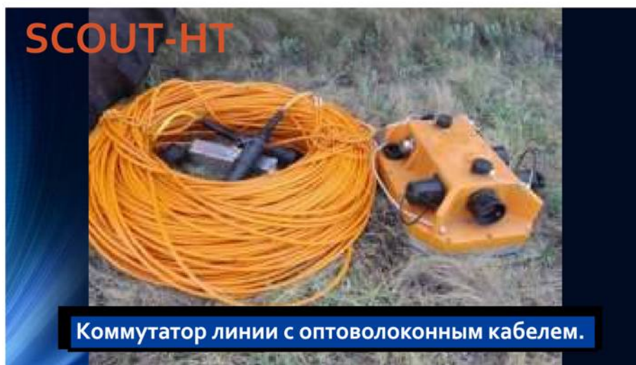
► Рис. 3. Блок концентратора линии наблюдения.
