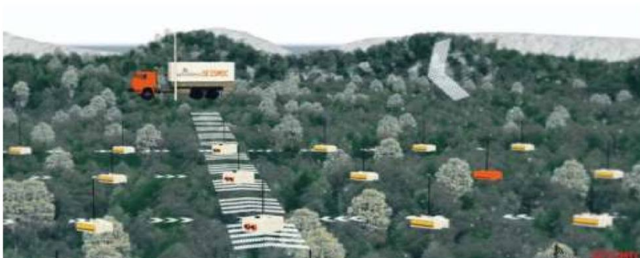
▲ Рис. 2. Расположение полевого оборудования и передача данных в центральную систему RT2.
