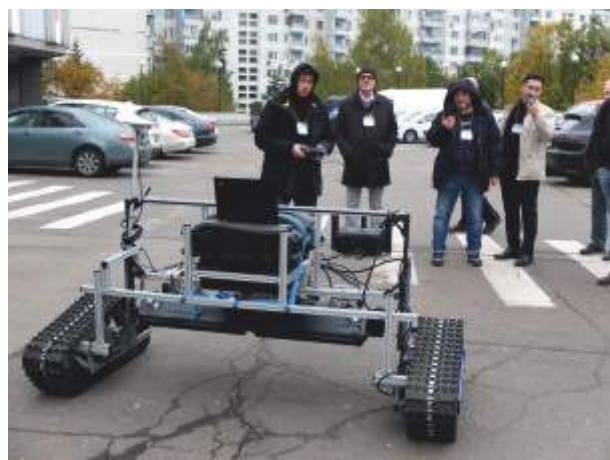
▼ Многокурсовой георадар TerraZond на автономной гусеничной платформе
