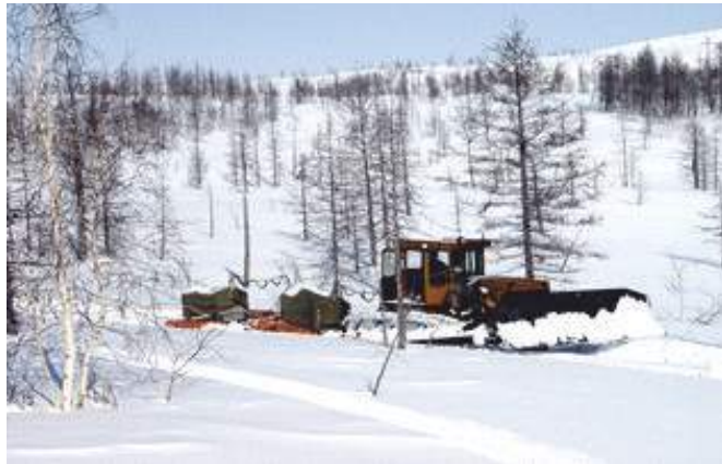
▲ Рис. 4. Санний «Енисей СЭМ – 50» на льду и сцепка «Енисей СЭМ-100».
