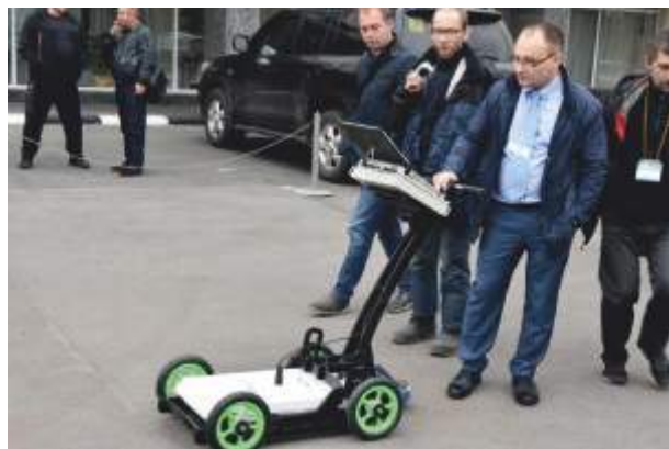
▲ Демонстрация георадара Zond 12e с антенной 900 МГц на ударостойкой тележке.
