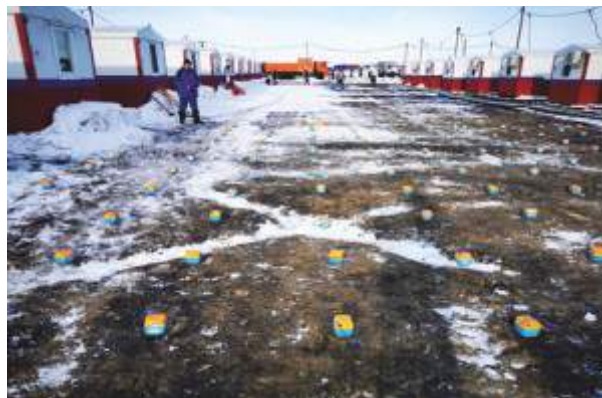
▲ Рис. 3. Расстановка патчевой системы пассивной наблюдения (10x10 м) на базе партии ТНГ-Групп.
