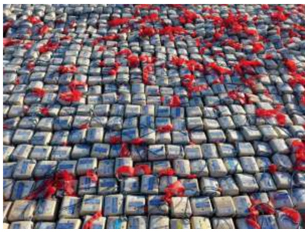
▼ Рис. 4. Датчики IGU-16HR 5Hz.
