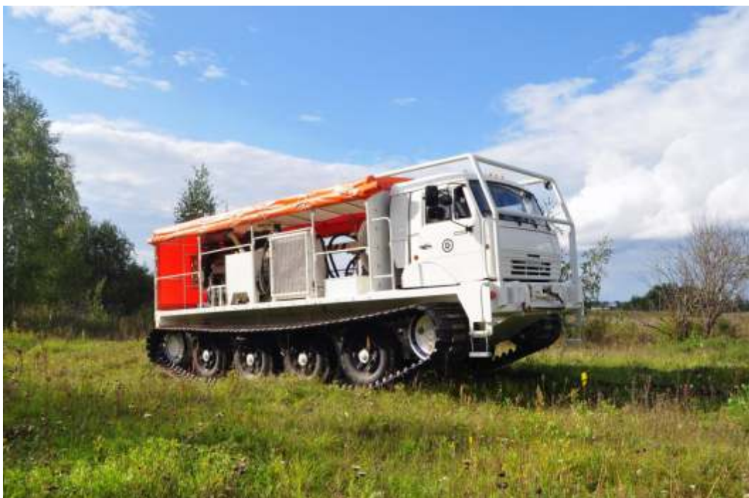
▼ Рис.1. Вибрационный источник сейсмических сигналов СВС-30-М1 (АО «Геосвип»).
