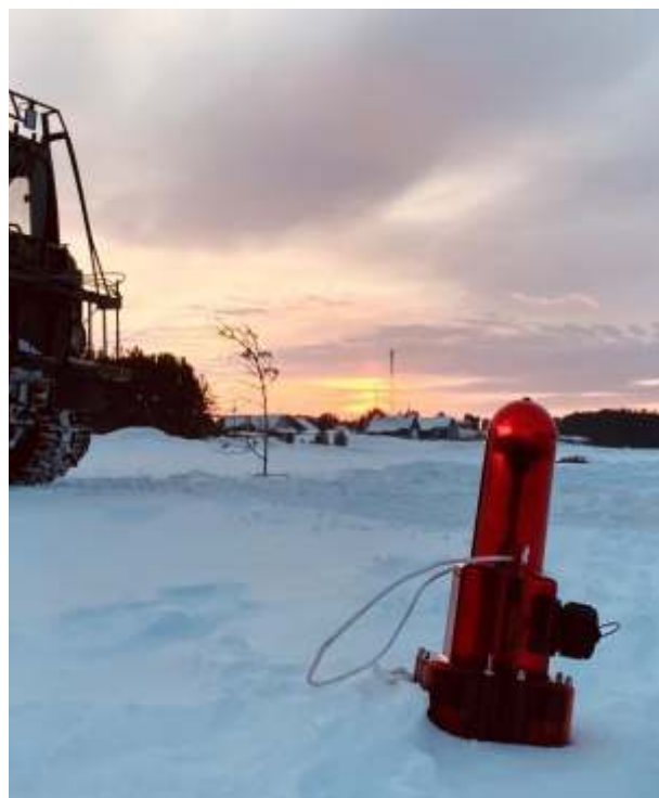
▼ Рис.3. Модуль бескабельной регистрирующей системы «Геотом» при полевых испытаниях в условиях Сибири.
