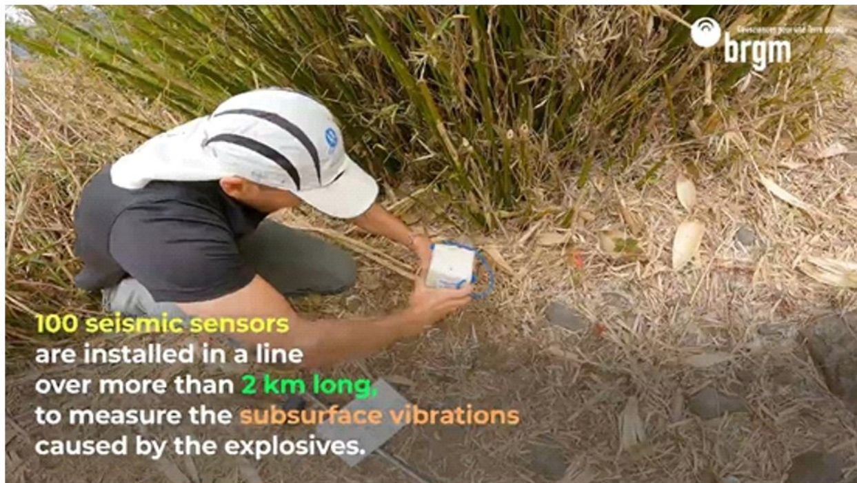
▲ Рис.2. Установка датчиков SmartSolo на проекте в цирке Салази, о.Реюньон
