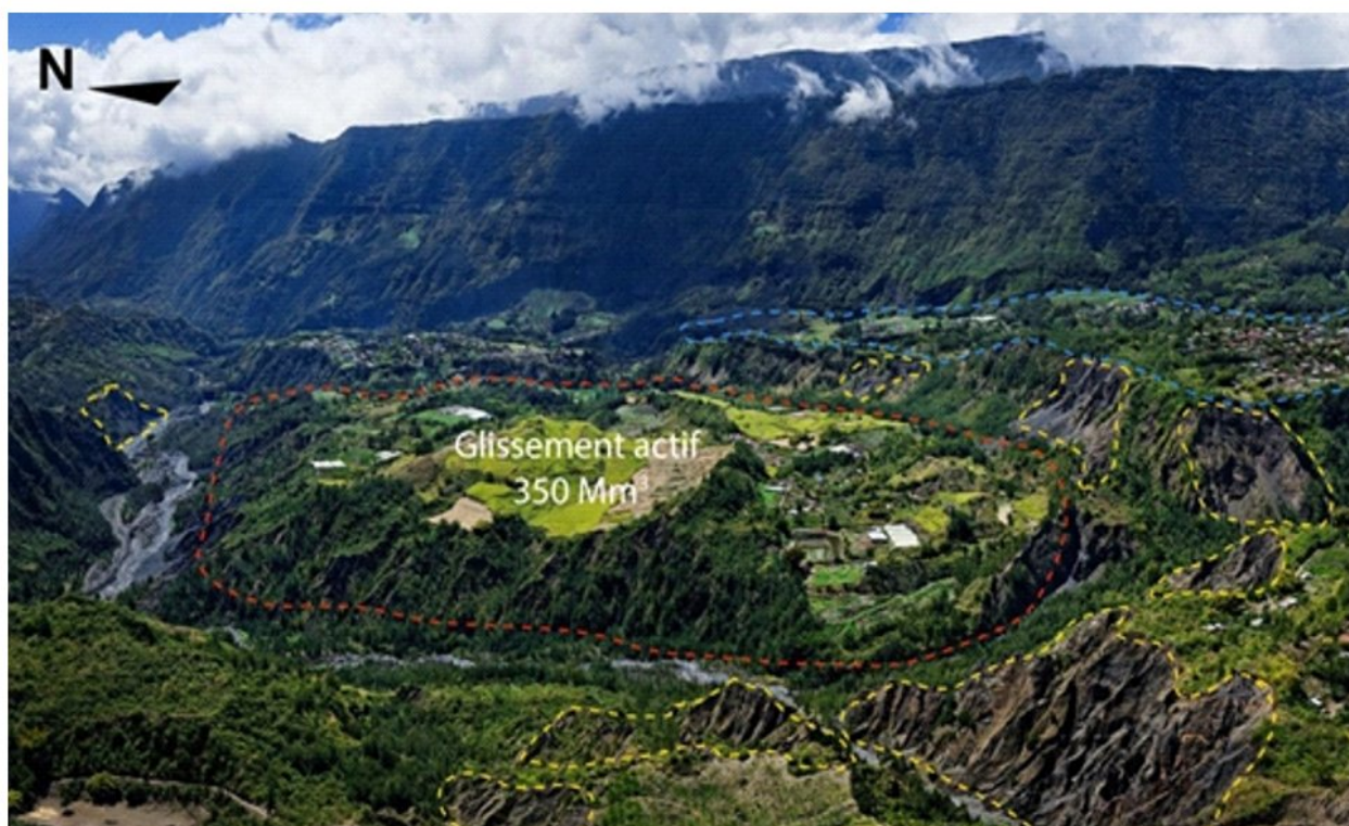
▼ Рис. 3. Активная эрозия оврагов во время сильных дождей. Желтые контуры обозначают примеры зон активной эрозии, синий контур-стабильный участок грунта.
