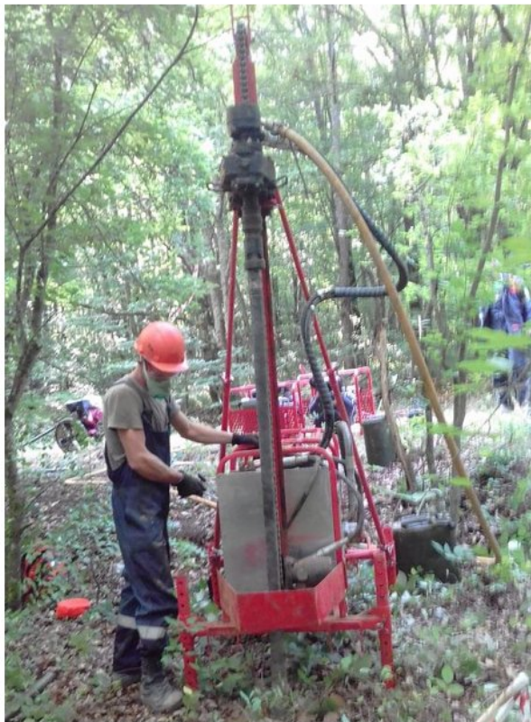
▲ ► Рис. 3. Буровая установка ZX-TD40 в работе на проекте на Северном Кавказе и в Индии..
