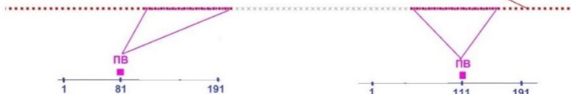
▲ Рис.1. Схема компенсации пропуска ПВ при работах 2Д.
