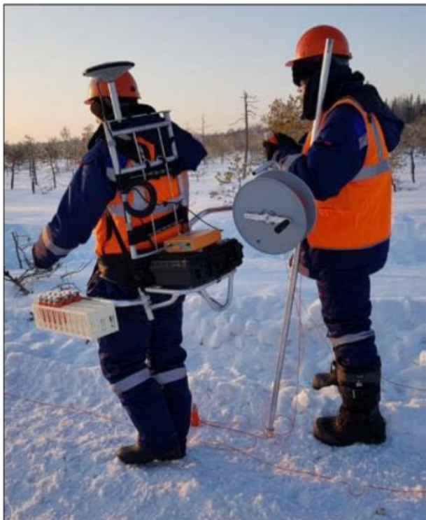
▲ Рис. 3. Выполнение опытно-производственных работ в Западной Сибири с использованием беспроводных единичных датчиков Nimble Node.
