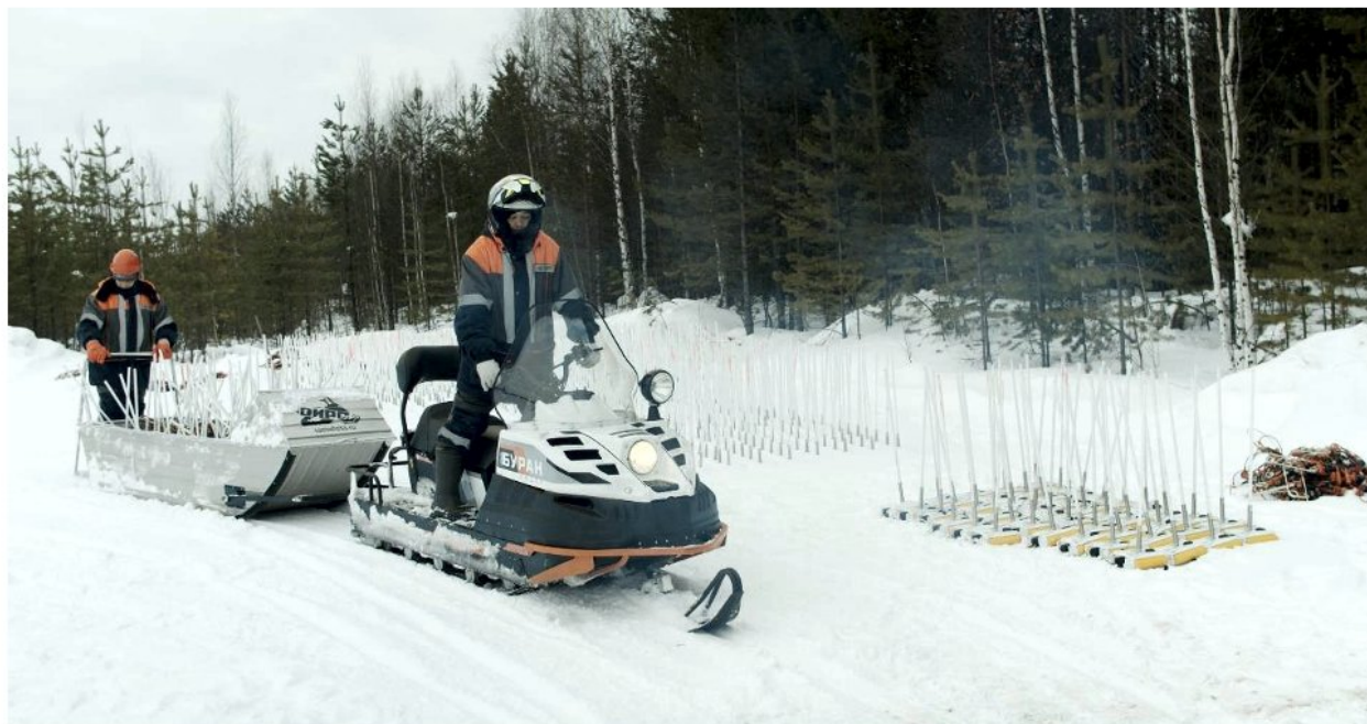
Рис. 3. Когда не нужны широкие просеки. Подготовка расстановки системы RT2.
