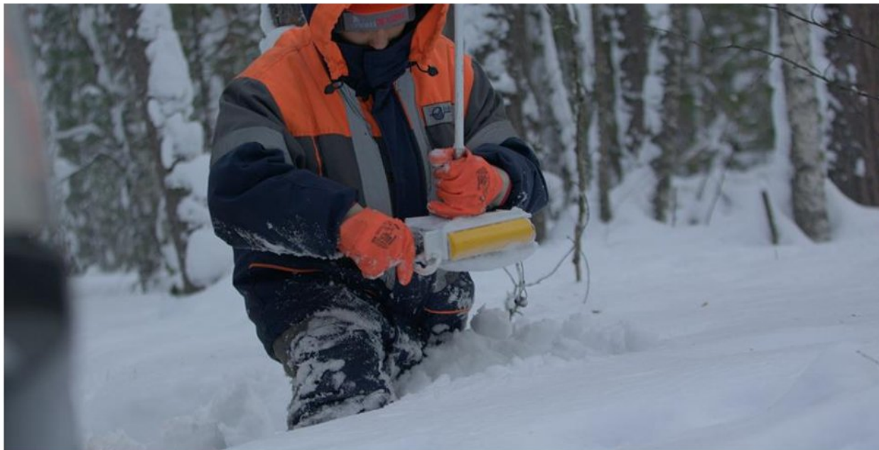
▲ Рис. 1. Установка WRU, бескабельного полевого регистрирующего блока RT2.
