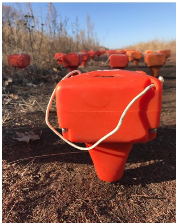
◀ Рис. 2. Автономные системы БАРС со встроенным геофоном – – новая разработка СКБ СП.
