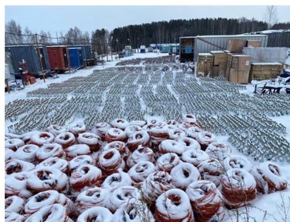
▲ Рис. 3. Проводное оборудование Sercel 428 и бескабельные модули WTU-508.
