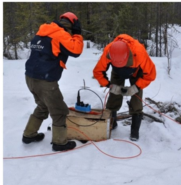
▲ Рис. 7. Размотка кабельного оборудования.
