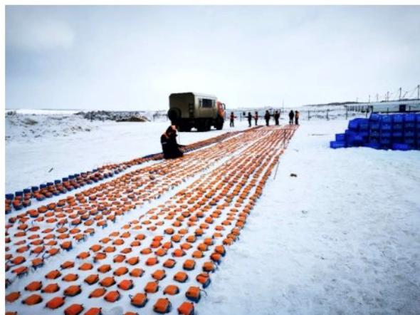
▼ Рис. 8. Тест на идентичность оборудования SmartSolo. Март 2021 года.
