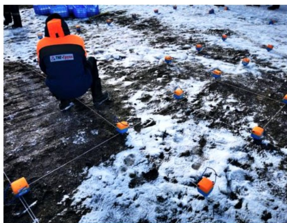
▼ Рис. 8. Тест на идентичность оборудования SmartSolo. Март 2021 года.
