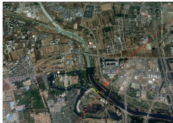
▲ Рис. 2. Район исследований Вэньюэхэ, Пекин. * Красная пунктирная линия - Хуанчжуан-Гаоляйн разлом (HGF); * ASLV – линия сейсмического профиля 2010 г.; * TT54, TT-59 и TT-61 – геотермальные скважины
