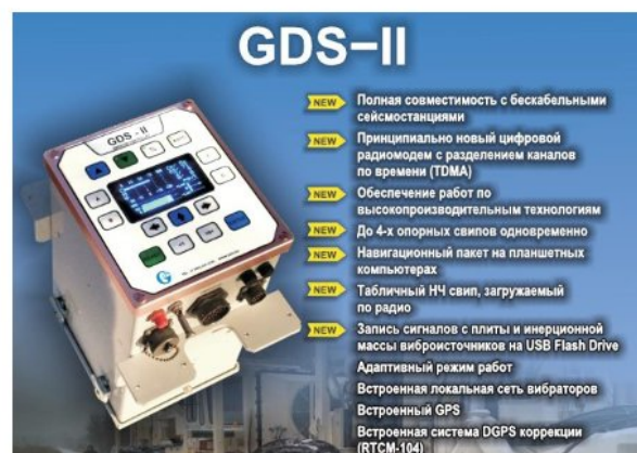
▲ Рис. 1. Блок управления сейсмическими вибраторами GDS-II, позволяющий проводить работы по методикам адаптивной вибрационной сейсморазведки.
