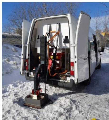
▼ Рис. 2. Вибрационный источник смонтированный на грузовой фургон «Ford Transit» (вверху) и на снегоболотоход «Лесник Профи» (внизу).
