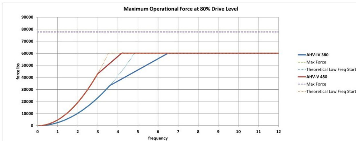
▲ Рис. 2. Теоретический график зависимости усилия от частоты вибросейсмического источника Titan и AHV-IV 380 Renegade. Увеличенный ход поршня Titan приводит к существенному увеличению усилия на низкой частоте.
