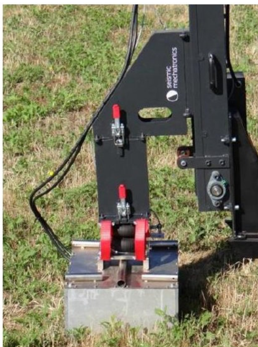
▼ Рис. 3. Слева - положение вибрационного узла для возбуждения поперечных волн, справа - для возбуждения продольных волн.
