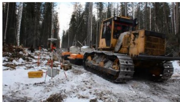
▲ Рис. 2. Спарка источников СЭМ-100 при динамическом возбуждении.
