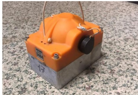
▲ Рис. 4. Трехканальный беспроводной автономный регистратор "SCOUT".
