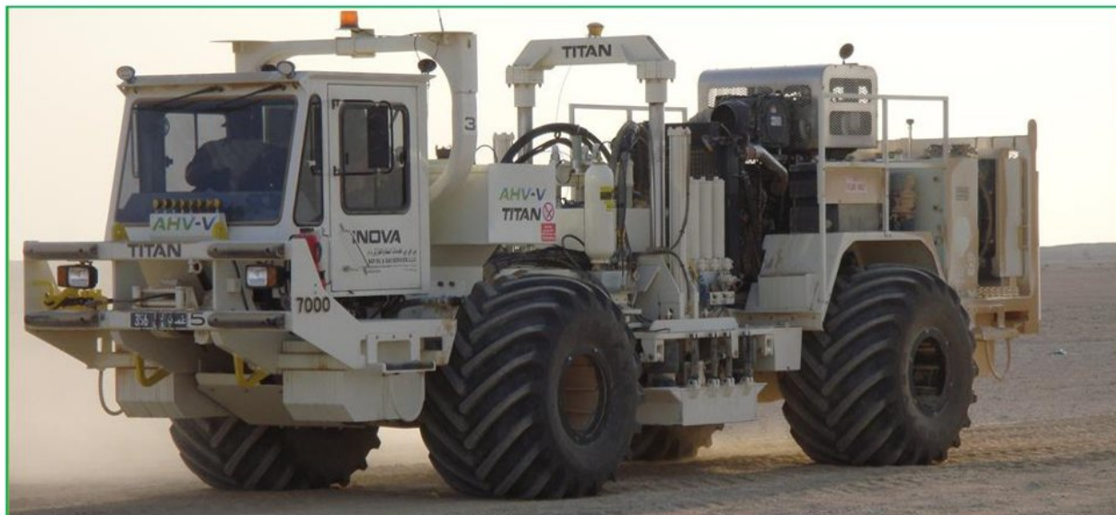
▲ Рис. 1. Новый вибросейсмический источник Titan, работающий во время полевых испытаний в пустыне.
