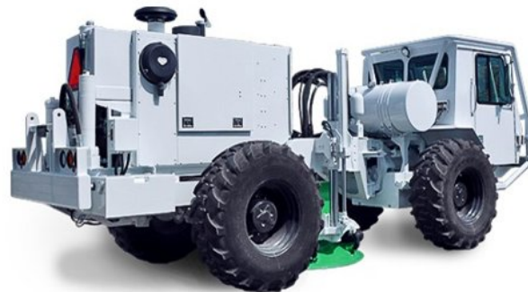
▲ Рис. 52. Вибрационный источник малой мощности EnviroVibe 2 («IVI») [57].
