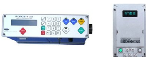
▼ Рис. 54. Дешифратор Force 2 и шифратор «Universal Encoder» («Seismic Source») [60].
