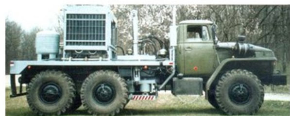
▼ Рис. 43. Сейсмический вибратор СВ-5-150М2 (Армавир, 1990) [47].
