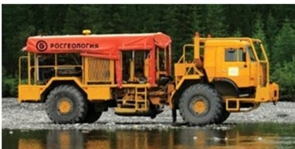
▲ Рис. 47. Сейсмический вибратор СВ-30/150Б «Русич» («Геосвип») [52].
