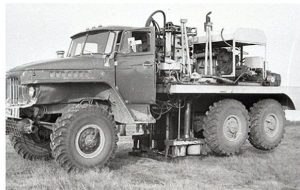
▼ Рис. 43. Сейсмический вибратор СВ-5-150М2 (Армавир, 1990) [47].
