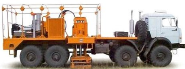
▲ Рис. 48. Вибрационный узел НЕМ150 («IVI») на шасси КАМАЗа («Татнефтегеофизика») [53].
