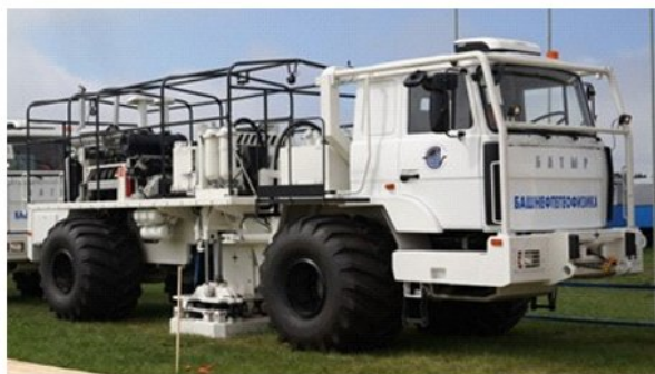
▲ Рис. 50. Сейсмический вибратор СГМ6 «Батыр» на шасси «багги» [55].
