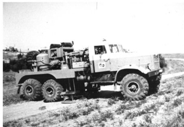
▲ Рис. 44. Сейсмический вибратор СВ-10/100 (Гомель) [49].
