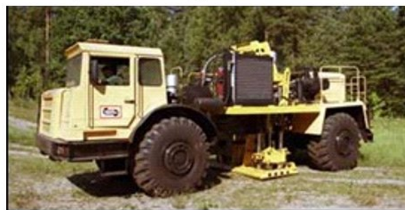
▲ Рис. 45. Сейсмический вибратор СВ-30/120 (Гомель) [50].
