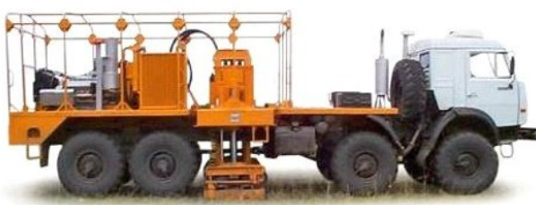
▲ Рис. 48. Вибрационный узел НЕМ150 («IVI») на шасси КАМАЗа («Татнефтегеофизика») [53].
