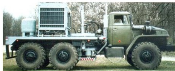
▼ Рис. 43. Сейсмический вибратор СВ-5-150М2 (Армавир, 1990) [47].
