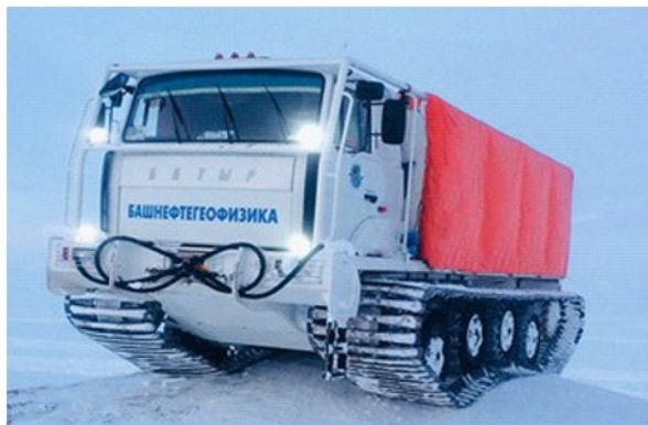
▲ Рис. 51. Сейсмический вибратор СГМ6 «Батыр» на шасси снего-болотохода [56].
