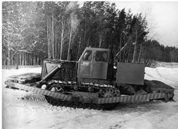
▲ Рис. 40. «Вибролокатор» - комплекс аппаратуры и оборудования для вибрационной сейсморазведки нефтяных и газовых месторождений [42].
