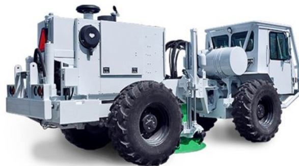
▲ Рис. 52. Вибрационный источник малой мощности EnviroVibe 2 («IVI») [57].
