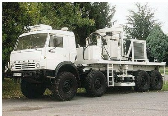
▼ Рис. 49. Виброузел Mertz M27/623B на базе шасси КАМАЗа («Башнефтегеофизика») [54].
