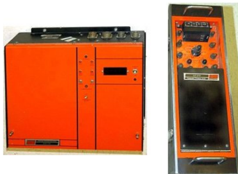
▲ Рис. 55. Система синхронизации SHV 310 («Geosource», 80-е годы) [24].
