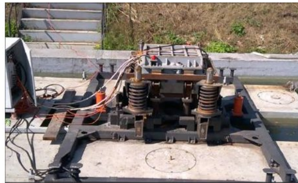
▲ Рис. 3. Ударный модуль ВИМС на геофизическом полигоне
