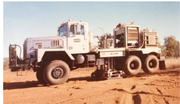
▲ Рис. 28. Сейсмический вибратор LRS 315 на шасси International [32].
