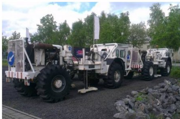
▲ Рис. 6. Сейсмический вибратор Mertz M10/601 [13].
