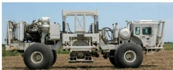
▲ Рис. 9. Сейсмический вибратор Mertz M18S/612 [17].
