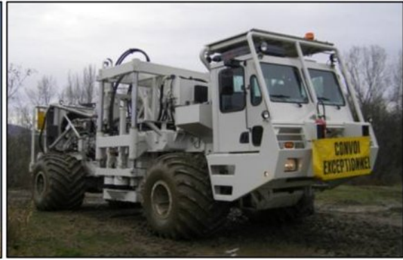
▲ Рис. 12. Сейсмический вибратор Mertz-Sercel M30/625 (DX80).
