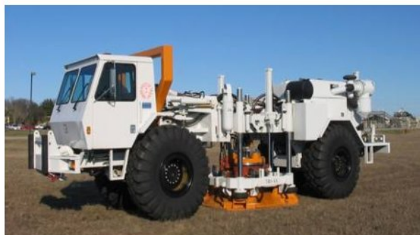
▼ Рис. 24. Сейсмический вибратор S-wave вибратор «IVI» [27].
