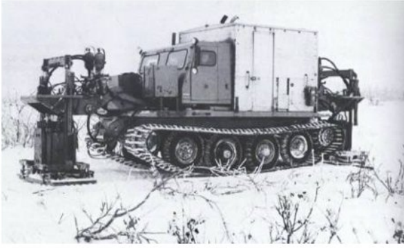
▲ Рис. 25. Сейсмический вибратор LRS с двумя виброузлами [29].
