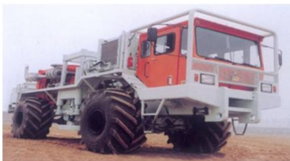
▼ Рис. 37. Сейсмический вибратор KZ-28 [40].
