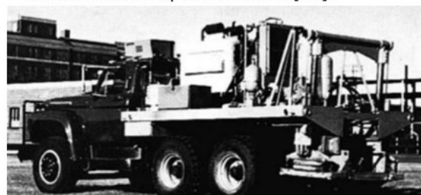
▼ Рис. 4. Первый сейсмический вибрационный источник поперечных волн [10].
