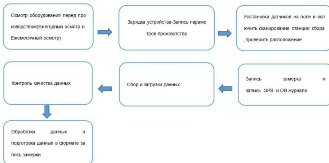
▼ Рис. 2. Организация полевых работ с использованием системы SmartSolo.
