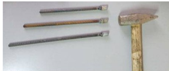
▲ Рис.2. Варианты анкеров для установки геофонов.
