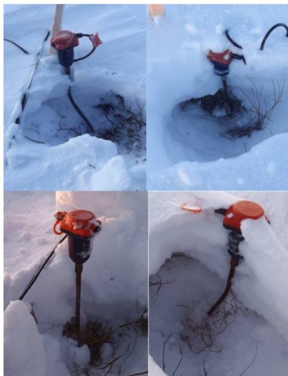
▲ Рис.3. Нарушения технологии установки геофонов.
