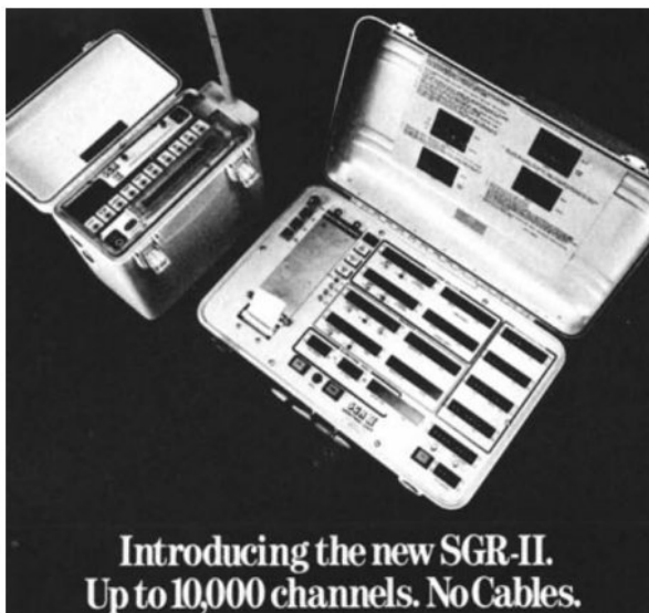
▼ Рис. 23. Автономные бескабельные системы регистрации SGR-II («GUS», 1982) [18].
