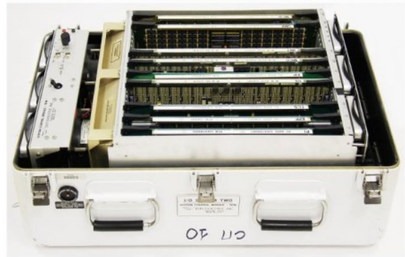
▲ Рис. 21. Центральный сейсмический модуль телеметрической сейсмической системы I/O SYSTEM TWO [29].
