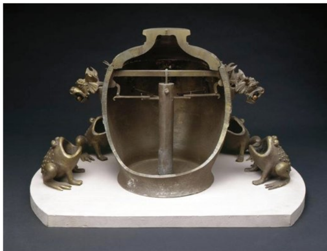
▼ Рис. 1. Сейсмоскоп Чжан Хэна. 132 г. Реконструкция [1].
