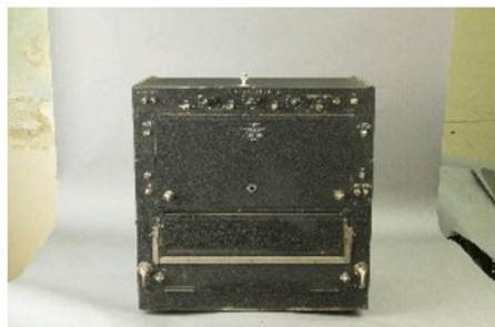
▲ Рис. 11. Осциллограф сейсмический ОС-60 (СС-60-55) на 12 каналов [16].
