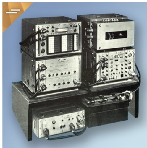
▲ Рис. 16. Цифровая сейсмостанция «Sercel» SN338. 1971 г. [25].
