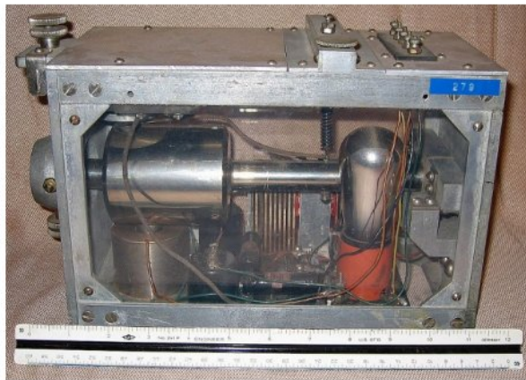
▲ Рис. 6. Сейсмограф вертикальный. «Petty Geophysical», 1925 г. [6].
