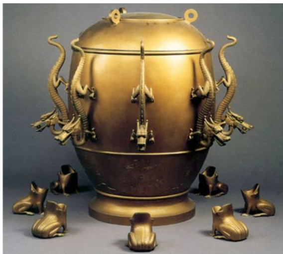
▼ Рис. 1. Сейсмоскоп Чжан Хэна. 132 г. Реконструкция [1].
