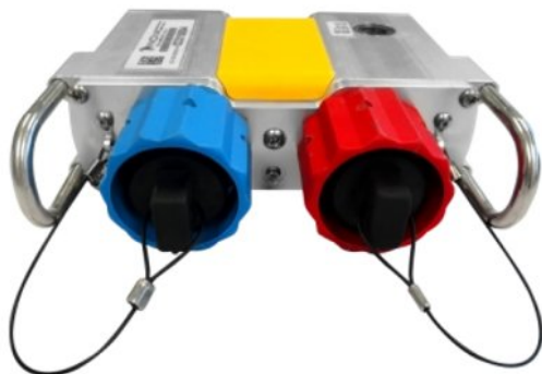
▼ Рис. 24. Бескабельная система Hawk («INOVA») [31].
