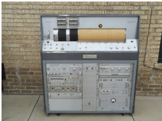
▲ Рис. 13. Сейсмостанция «SIE» MR-12 (24 канала).
