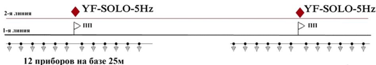
▲ Рис. 2. Профиль №3. Схема расположения сейсμοприемников: 1-я линия группы GS-20DX, 2-я линия- одиночные YF-SOLO-5Hz.
