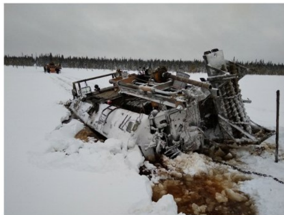
▲ Рис. 1. Провалившаяся техника на подтаявшей переправе. Западная Сибирь.
