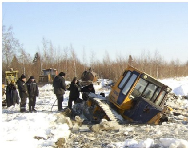
▼ Рис. 4. Подъем бульдозера с использованием спасательной конструкции. Республика Коми.
