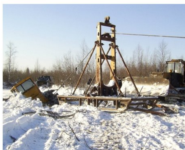
▼ Рис. 4. Подъем бульдозера с использованием спасательной конструкции. Республика Коми.
