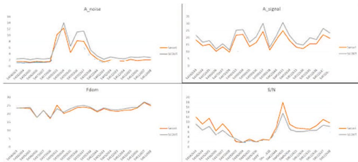
▲ Рис. 2. Сравнение атрибутов записей, полученных сейсмосистемой Sercel и сейсмосистемой «SCOUT».
