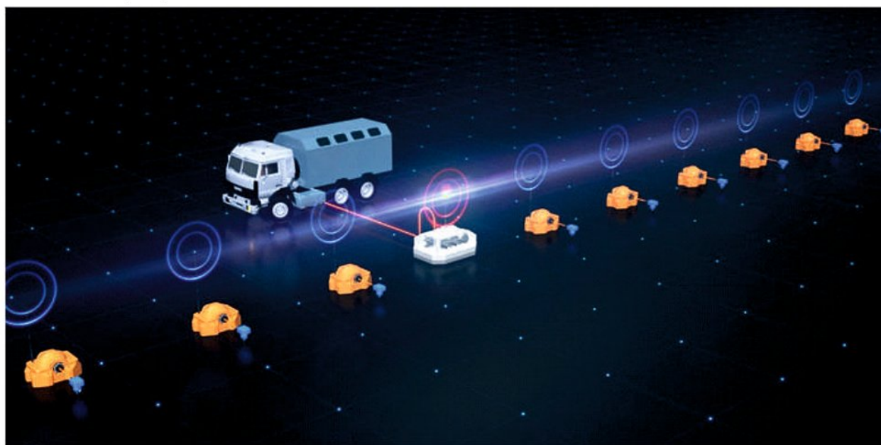
▼ Рис. 3. Принцип организации передачи информации в линии. Каждая часть линии передает информацию в коммутатор, который затем передает ее в управляющий компьютер через кабель.
