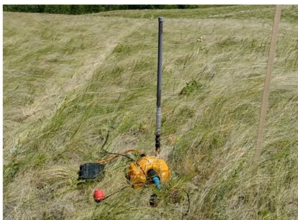
▼ Рис. 6. Беспроводной блок БАР в работе на профиле.
