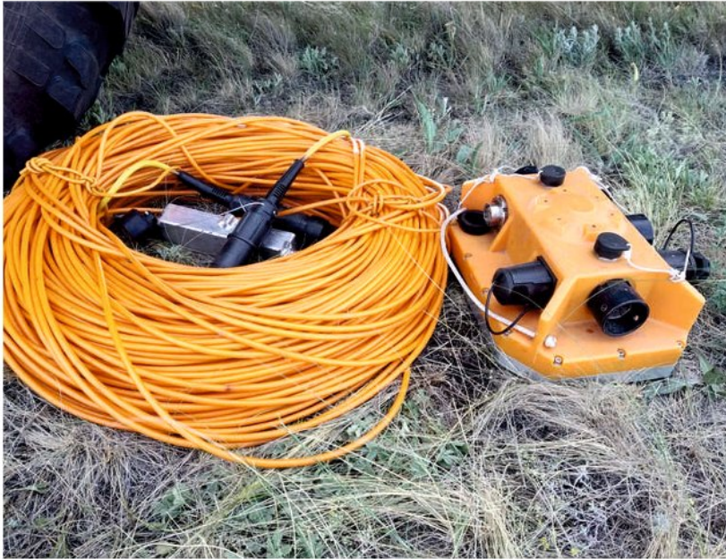
◀ Рис. 4. Внешний вид коммутатора линии с оптоволоконным кабелем длиной 330 м. Коммутатор обеспечивает прием, обработку и передачу информации с БАР каждой линии в управляющий компьютер.
