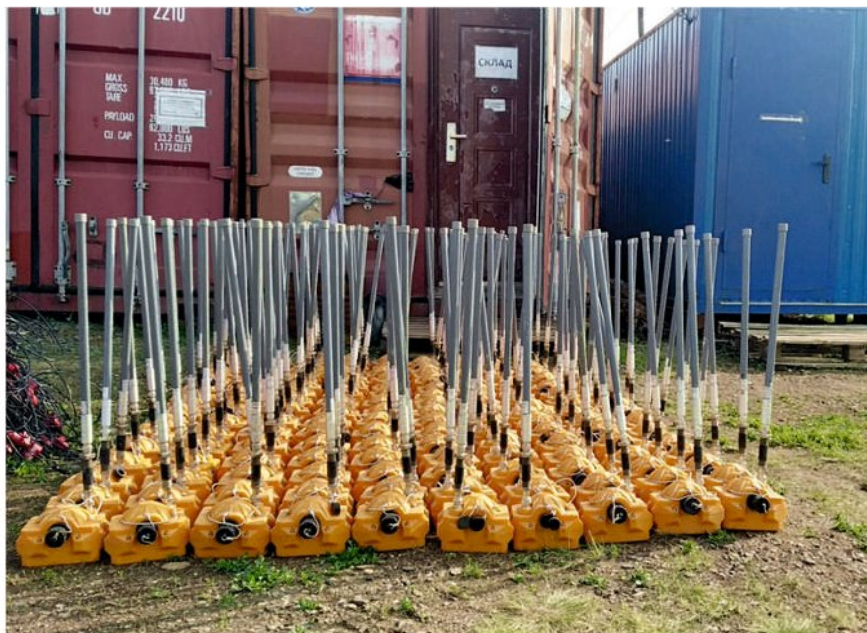
◀ Рис. 5. Подготовка беспроводных блоков БАР к работе в полевом лагере.
