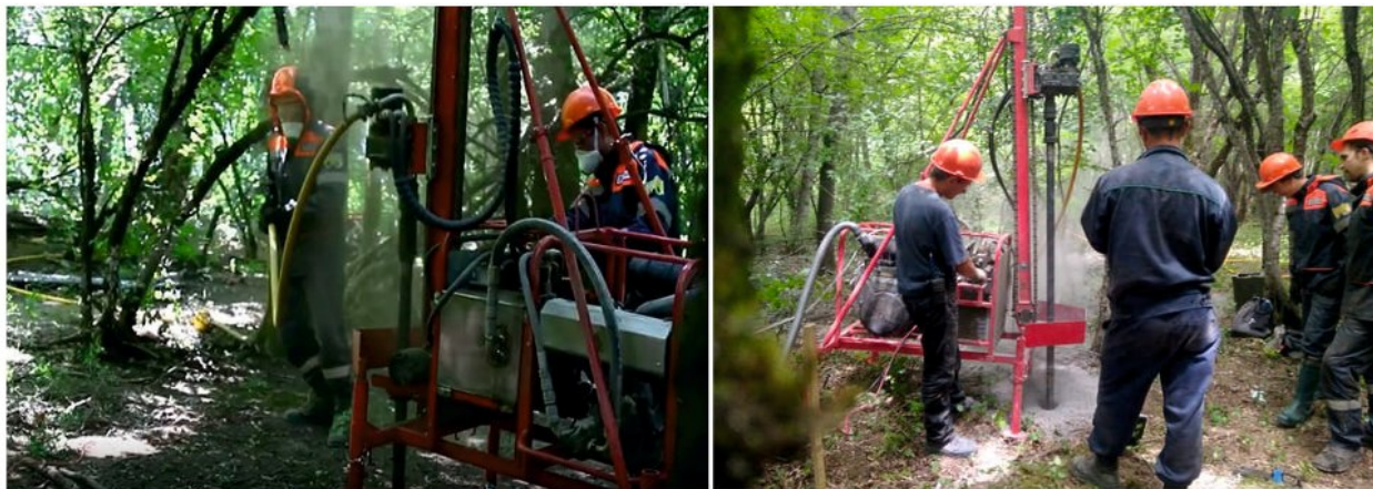
▲ Рис.2,3. Мобильные буровые установки, использованные на горном проекте ТНГ-Групп.
