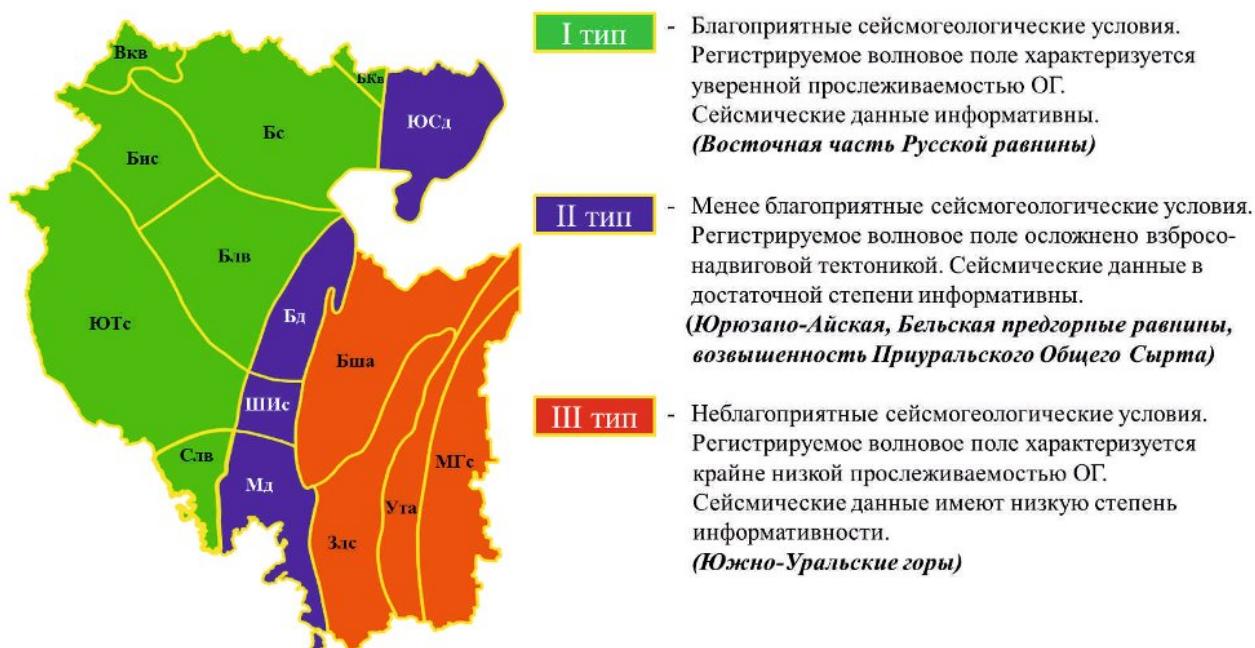
▲ Рис. 3. Дифференциация регистрируемого волнового поля по сейсмогеологическим условиям тектонических блоков. По данным ПАО АНК "Башнефть", 01.11.2017.
