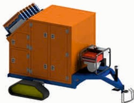
▲ Рис. 5. Автоматизированные прицепы на колесном или гусеничном ходу, несущие до 300 регистраторов NRU, вдавливаемых в грунт по команде оператора в специально подготовленные лунки.
